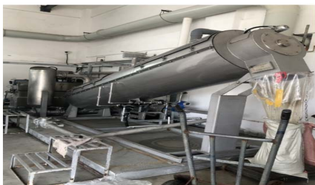
图2 粪便无害化处理系统中的絮凝脱水设备
