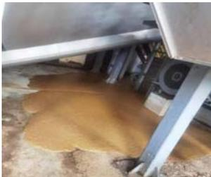
图3 缓存箱冒罐导致浆料溢出
