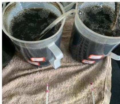
好氧泥水混合物(未稀释),24小时小试硝化结果见下表。左杯为空白,右杯为加菌40ml样,硝酸盐显色右杯明显
