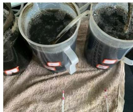
好氧泥水混合物(稀释约1倍),24小时小试硝化结果见下表。左杯为空白,右杯为加菌40ml样,硝酸盐显色右杯明显通过高效生物菌种试验说明:
