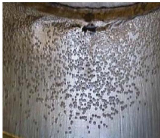
图1 管壁氧腐蚀点
