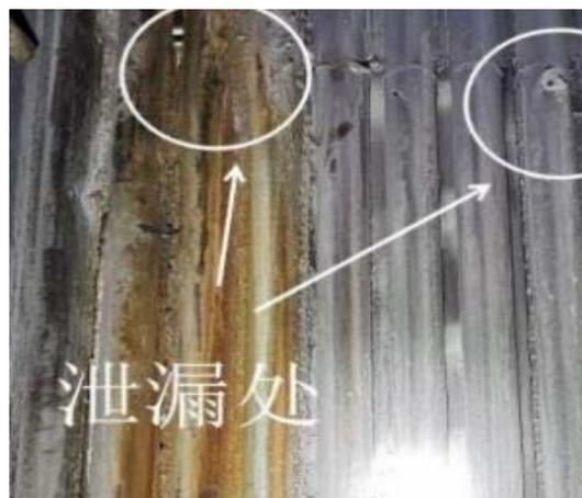
图2 管壁腐蚀
